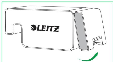
3. Tournez le bas de la batterie portable vers le haut et loin de l'imprimante, puis tirez la partie supérieure de la batterie portable loin de l'imprimante pour déconnecter complètement la batterie portable.
