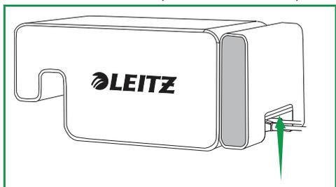
2. Appuyez sur le taquet de la batterie portable pour l'ouvrir et inclinez la partie inférieure de la batterie portable loin de l'imprimante comme illustré.
